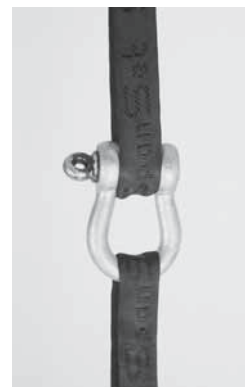
Fig. 4: fasce raccordate correttamente.
